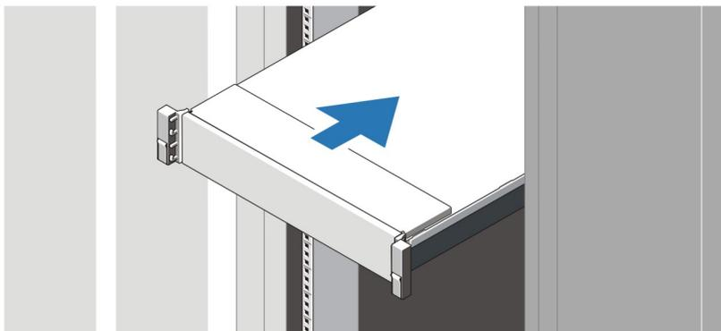
Figure 1. Installation des rails et du système dans un rack
