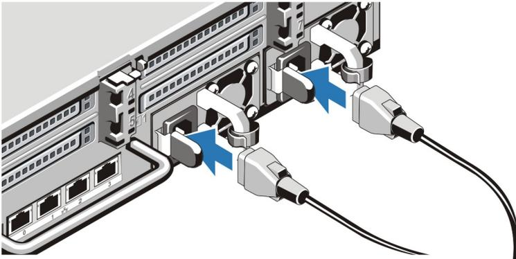
Figure 3. Branchement du ou des câbles d'alimentation
